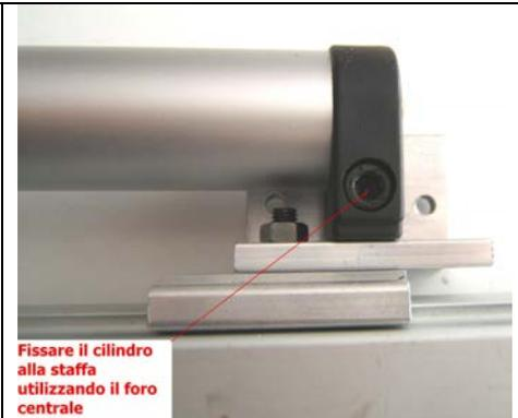
**Fig. 7 Fissaggio lato posteriore**
