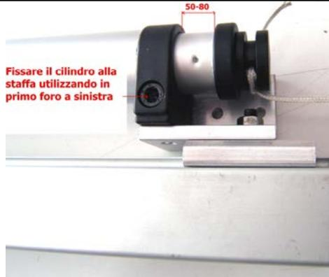
**Fig. 3 Fissaggio lato anteriore**
